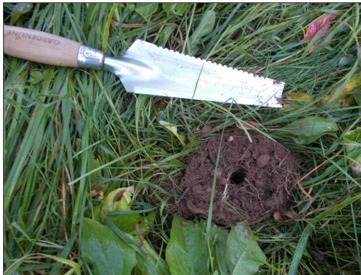
Abb. 15: Minimale Bohrspuren des Feldroboters
