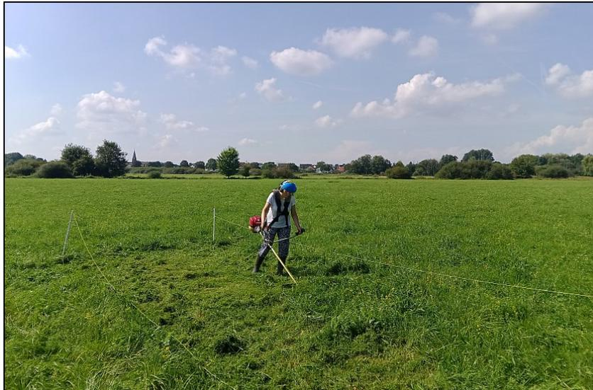
Trotzdem bildet abgerissene Vegetation bei jedem Ansatz des Bohrers ein Polster, das weiteres Eindringen des Bohrers verhindert. Erst nachdem dies vom Bohrer entfernt ist und der Bohrer auf blanker Erde angesetzt wird, geht der eigentliche Bohrvorgang problemlos. Aus Sicherheitsgründen muss zu jedem Reinigungsvorgang die Bohrmaschine abgeschaltet und anschließend neu gestartet werden.
